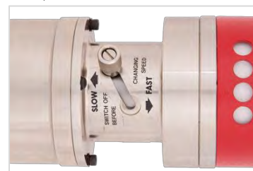
FIGURA 10 – Funzione "VELOCE" in alto, velocità "BASSA" sotto.
