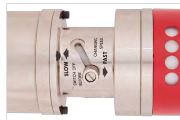
FIGURA 10 – Funzione "VELOCE" in alto, velocità "BASSA" sotto.
