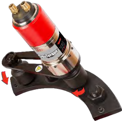
ABB. 5 – Entgegengerichtetes Drehmoment (Vorwärtsbetrieb)
